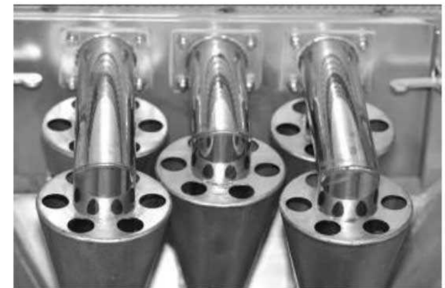
Zyklon-Anlage Cyclone installation Séparation cyclonique
